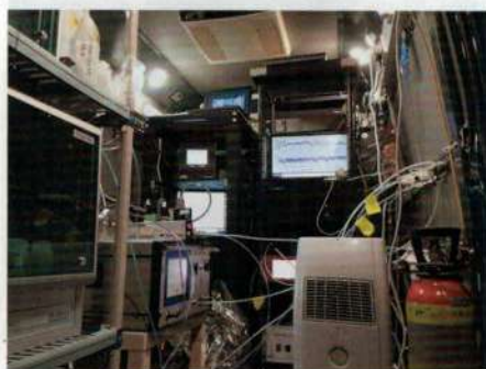
6: Innenansicht des thermostatisierten Fahrzeugs, mit optischen Messgeräten, Druckgasflasche mit einem \text{NH}_3 -Referenzgasgemisch und dem mobilen Referenzgasgenerator ReGaS1.
