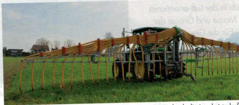
2: Ammoniakemissionen werden in der Schweiz zu 95% durch die Landwirtschaft verursacht. Emissionsreduzierende Techniken bei der Gülleausbringung – Schleppschlauchverteiler anstelle eines herkömmlichen Pralltellers – tragen erhebliche Emissionsreduktion bei.
