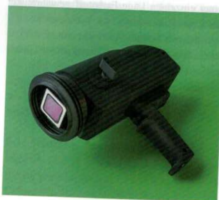
Demonstrator einer mobilen Messpistole mit lumineszenter Trägerfolie © Fraunhofer IST / Falko Oldenburg
