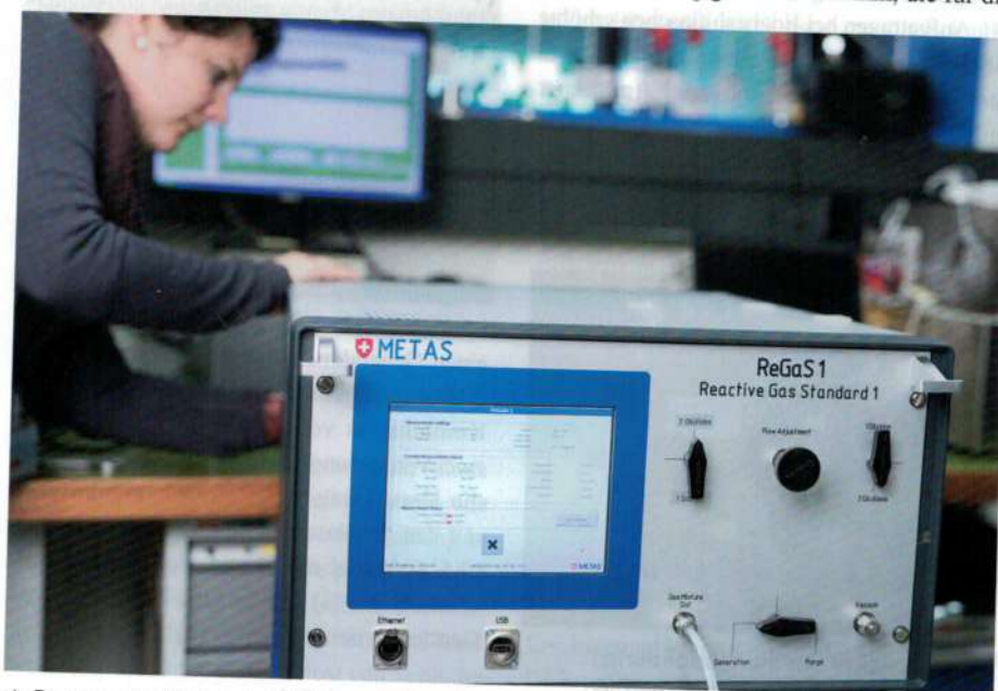
4: Der vom METAS entwickelte mobile Referenzgasgenerator (ReGaS1) kann zur Herstellung von rückführbaren \text{NH}_3 -Referenzgasgemischen vor Ort eingesetzt werden. Weitere Erläuterungen im Film auf: www.metas.ch/gas
